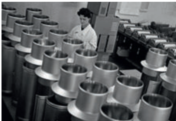
Рижский завод «Гидрометеоприбор». Сотрудница отдела технического контроля проверяет качество плувиографов, приборов для регистрации количества, продолжительности и интенсивности осадков. Латвийская ССР. 1965 год. Фото РИА Новости
