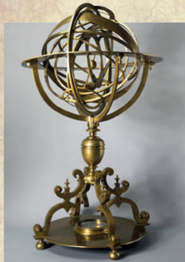
Армиллярная сфера, представляющая строение Солнечной системы по геоцентрической теории Птолемея. Начало XVIII века
